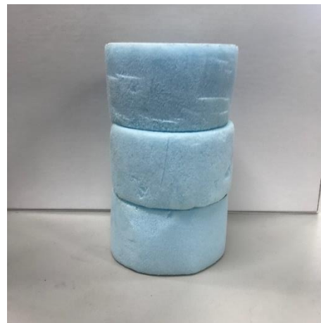
図 2 発泡スチロールによる断熱
