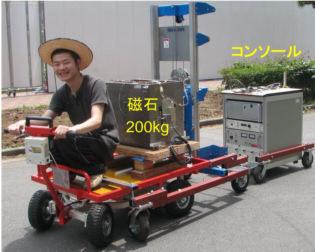
磁石をリフトに載せ、それを電動台車に搭載して、コンソールを牽引する。
