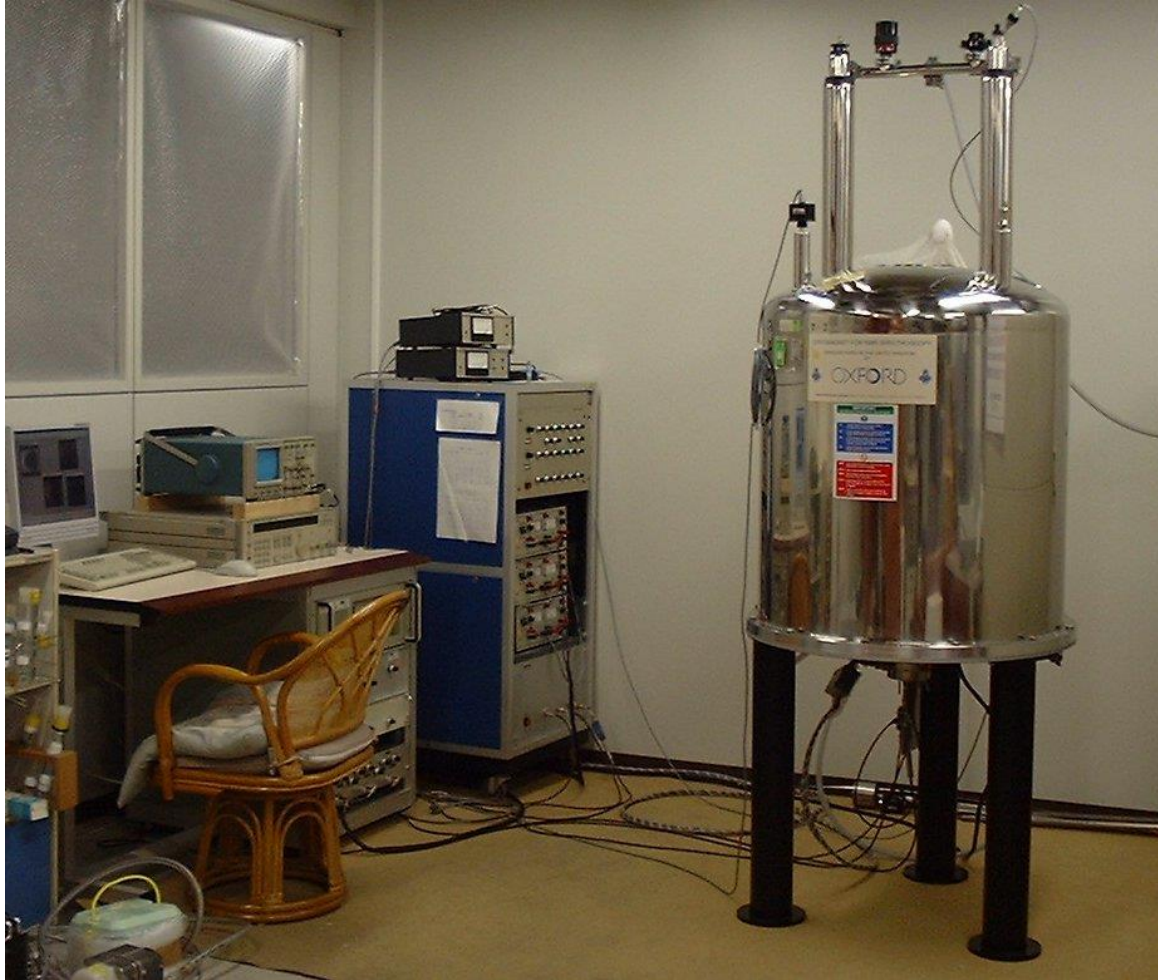
4.7T超伝導磁石を用いたMR microscope
